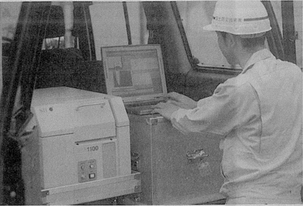
写真1 若手会員による現場での蛍光X線分析作業
